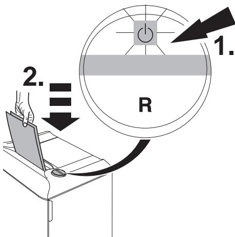
**E** Presionar botón (1.) a luz verde indica que está listo para funcionar. Inicio automático con el indicador en verde en caso de inserción de papel. Modo de espera automático que se apaga tras 30 minutos. La máquina puede apagarse en cualquier momento pulsando la tecla durante 2 segundos. El indicador LED verde se apaga . Con ello, no hay habrá ningún consumo.
