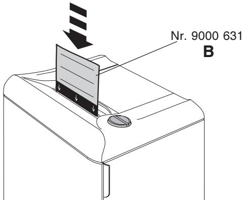
**D** Bei nachlassender Schneidleistung oder nach jedem gefüllten Auffangbehälter Schneidwerk ölen! (siehe Bild)
