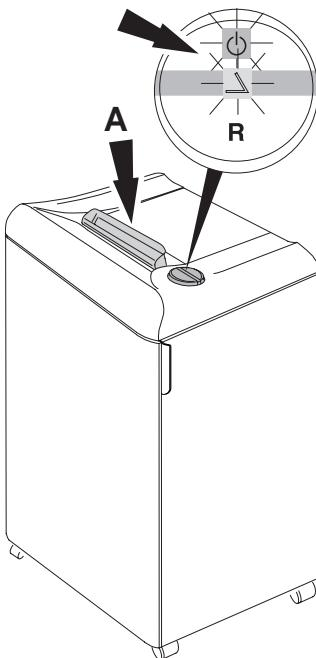
**NL** Automatische stop als de veiligheidsklep (A) geopend wordt (Symbolen  $\Delta$  en  $\odot$  knipperen afwisselend.)
