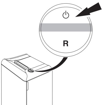
**D** Autom. standby - Abschaltung nach 30 Minuten. Maschine kann jederzeit durch 2 sec. langes Drücken des Schalters ausgeschaltet werden. Grüne Kontrollleuchte erlischt. Danach verbraucht die Maschine keinen Strom mehr.
