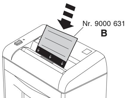
**D** Bei nachlassender Schneidleistung oder nach jedem gefüllten Auffangsack Schneidwerk ölen! (siehe Bild)
