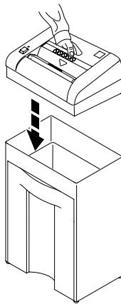
**D** Maschine in den Auffangbehälter bzw. Unterschrank setzen.
